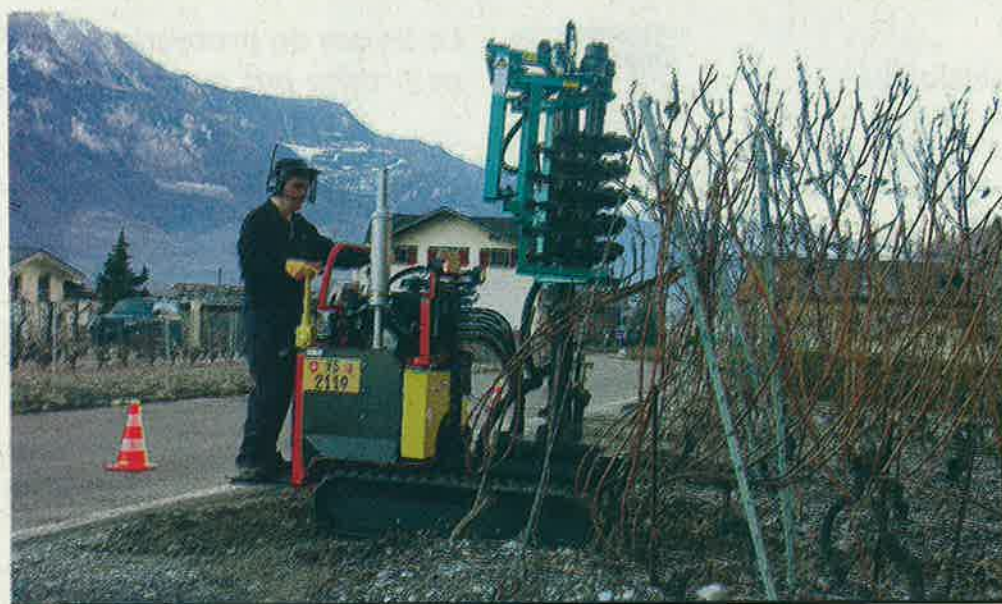
Une chenillette conduite depuis un marchepied ou un siège n'est pas assimilée aux cycles; il s'agit d'un véhicule spécial qui nécessite une immatriculation en plaque brune pour circuler sur la route.
